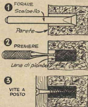
guardatevi dalla lana di ferro), pressandovela bene, in modo che riempia tutta la cavità, sino ad uno o due mm. dalla superficie della parete. Quindi metete a posto la vite, che avrete un po' lubrificata, interponendo tra la testa di questa e la parete un dischetto di legno, il quale, una volta stretta la vite, impedirà al metallo di uscire dal foro. Questi, d'altra parte, spinto contro le pareti del foro dalla vite stessa, offrirà una presa tenacissima.
