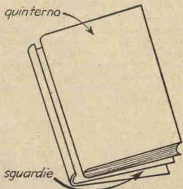
FIG.14 - Come si applicano le sguardie ai due quinterni di testa e di fondo del volume
