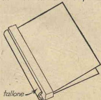
FIG.13 - Modo di formare il tallone alle sguardie
