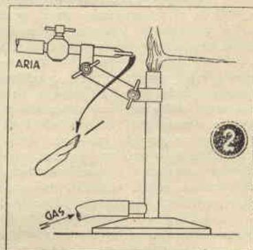
vola saldata al serbatoio, mentre un altro tubo di gomma di conveniente lunghezza unirà il serbatoio al rubinetto fissato al becco Bunsen.
