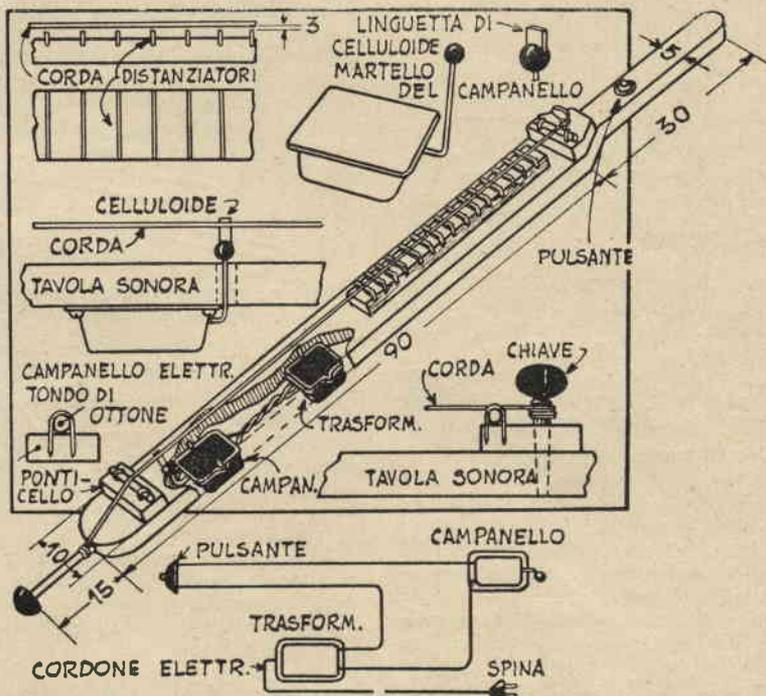
tondata dall'altra, nella quale è praticato un foro per l'alloggio di un tondino di acciaio lungo cm. 15, terminante con un puntale di caucciù semisferico. Blocchi di legno dolce formano i ponticelli per la corda, che è mantenuta in tensione da una chiave tolta ad un vecchio banjo o ad una chitarra fuori uso e
