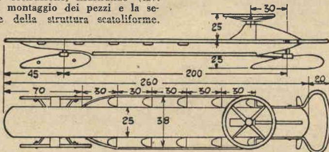
Si raccomanda di usare viti di ottone o di ferro galvanizzato, di affogarne le teste nel legname e di usare una colla alla caseina, resistente all'umidità. Le traverse di sostegno sono di pino di cm. 2 di spessore, e dello stesso legname sono le fiancate, nelle quali, a cm. 30 l'una dall'altra sono praticate
